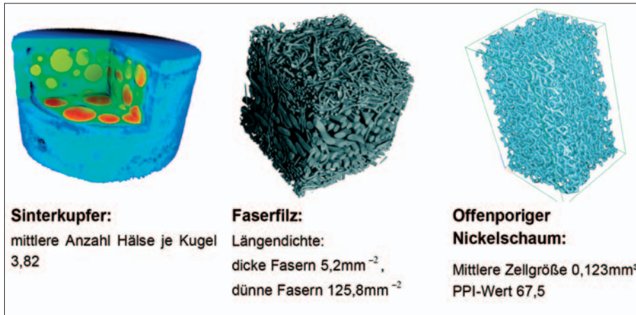
Bild 5. Beispiele für Kenngrößen verschiedener Materialien. Die Kenngrößen basieren auf den Minkowski-Funktionalen.
